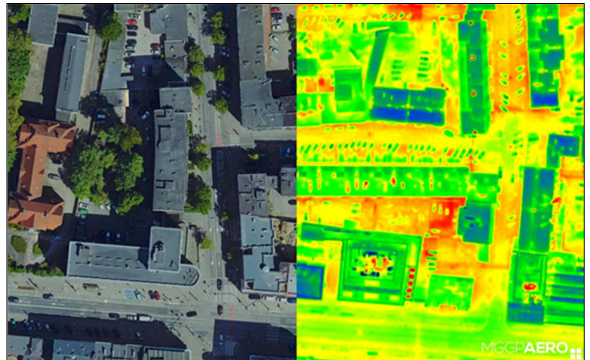
Rys. 7.3.2 Przykładowy widok termowizyjnej mapy strat ciepła dla budynków w Gdyni, Rumii, Redzie i Wejherowie dostępnej na stronie internetowej OPEC Gdynia. https://opecgdy.com.pl/
